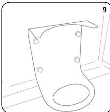
Wiederholen Sie die Schritte 4 bis 8 für alle 4 Befestigungslöcher, um die Tropfschalenhalterung am Nexus 100-Gehäuse zu befestigen.
