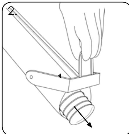
2. Öffnen Sie mit dem Edelstahlring den Schnellverschlussmechanismus, um die Becher zu entfernen.
