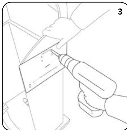
Öffnen Sie den Deckel und entfernen Sie die Tür des Behälters. Richten Sie TEIL 13 an den vorhandenen Löchern an der Oberseite des Nexus 100 aus. Wiederholen Sie Schritt 1 & 2, um die 4 neuen Löcher oben in dem Behälter zu bohren.
