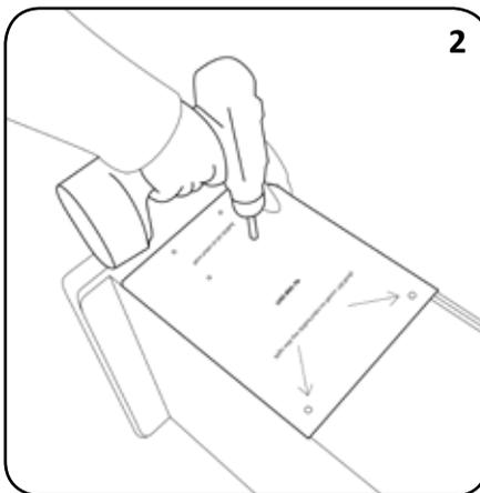
Legen Sie den Behälter auf die Seite, bohren Sie mit der Bohrmaschine die 4 neuen Löcher in den Behälter, wie auf der Schablone angegeben. Sobald Sie fertig sind, entfernen Sie die Befestigungen und die Papierschablone vom Behälter.
