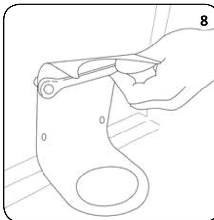
Halten Sie TEIL 5 fest und ziehen Sie TEIL 6 mit dem Schrauben- und dem Inbusschlüssel am Nexus 100-Gehäuse fest.
