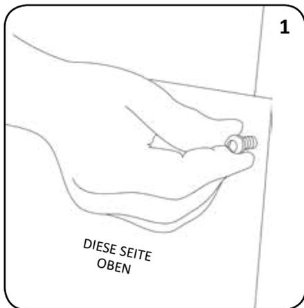
Platzieren Sie Teil 14 auf der rechten Seite des Behälters. Richten Sie die Schablone anhand der Löcher im Körper aus, und stoßen Sie diese mit einem Bleistift durch. Verwenden Sie 2 x TEIL 1 & TEIL 12, um die Schablone vorübergehend zu fixieren.
