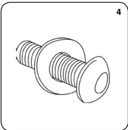
Platzieren Sie TEIL 3 auf TEIL 2. Drücken Sie die Schraube mit der Unterlegscheibe von der Innenseite des Behälters durch eines der vier Befestigungslöcher an der Unterseite des Behälters.
